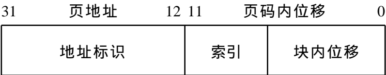
图 4.58 IBM3033 的 Cache 中索引和页内位移的关系
